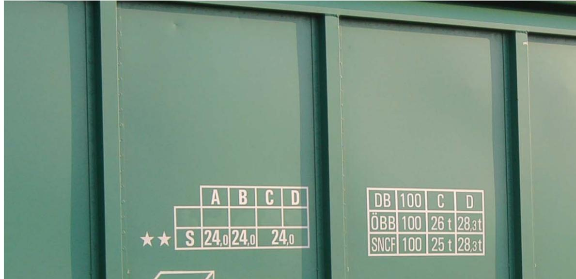
Bemerkung 1: Die Anschrift zur Streckenklasse D befindet sich nur an Wagen, die bei der Streckenklasse D eine größere Radsatzlast zulassen als bei der Streckenklasse C. Die Anschrift zur Streckenklasse E befindet sich nur an Wagen, die bei der Streckenklasse E eine größere Radsatzlast zulassen als bei der Streckenklasse D.
