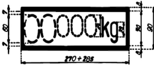
Bild 2: Eigengewicht des Wagens und Bremsgewicht der von der Plattform aus bedienbaren Handbremse
